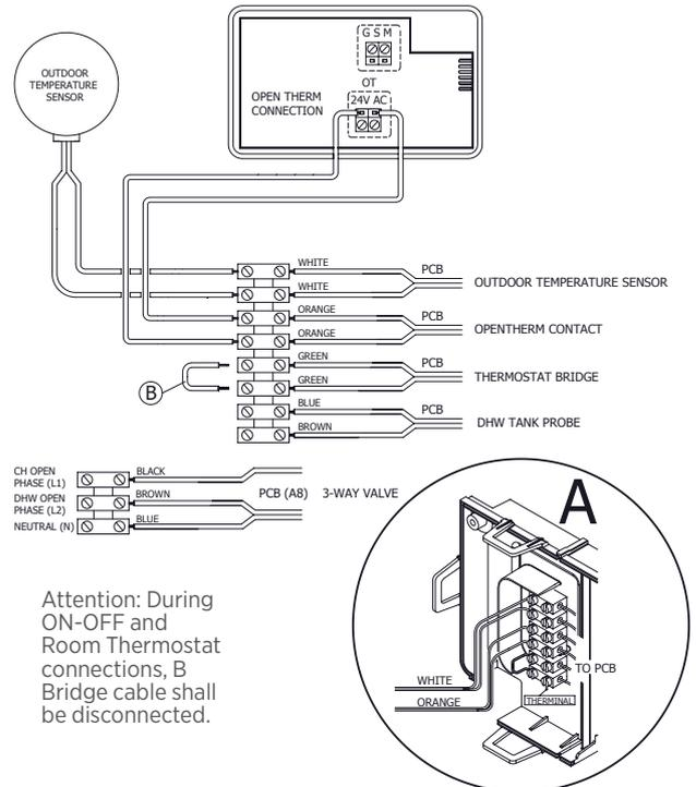
Şekil 27 Kazan oda termostati ve dış hava sıcaklık sensörü bağlantıları.
