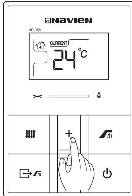
Επιλέξτε την επιθυμητή θερμοκρασία ανάμεσα στους 10 και στους 40 βαθμούς και αυτή θα αποθηκευτεί αυτόματα. Η θερμοκρασία μπορεί να οριστεί σε διαστήματα του ενός βαθμού. Η λυχνία λειτουργίας καύσης ανάβει και η θέρμανση ξεκινά, όταν η θερμοκρασία εσωτερικού χώρου είναι χαμηλότερη από την επιλεγμένη επιθυμητή θερμοκρασία. Εάν θέλετε να σταματήσετε τη θέρμανση χώρου, τότε μπορείτε να επιλέξετε θερμοκρασία χώρου 10 βαθμών.
