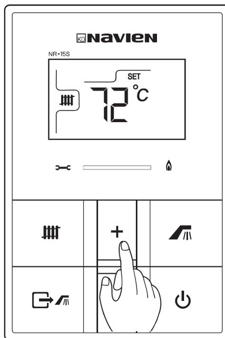
Επιλέξτε την επιθυμητή θερμοκρασία ανάμεσα στους 40 και στους 80 βαθμούς και αυτή θα αποθηκευτεί αυτόματα. Η θερμοκρασία μπορεί να οριστεί σε διαστήματα του ενός βαθμού. Η λυχνία λειτουργίας καύσης ανάβει και η θέρμανση ξεκινά, όταν η θερμοκρασία νερών είναι χαμηλότερη από την επιλεγμένη επιθυμητή θερμοκρασία. Εάν θέλετε να σταματήσετε τη θέρμανση χώρου, τότε μπορείτε να επιλέξετε θερμοκρασία νερών 40 βαθμών.
