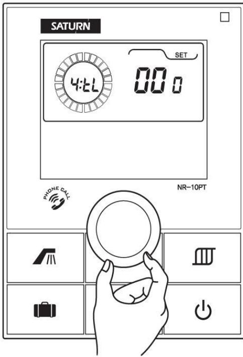
Περιστρέψτε τον περιστροφικό διακόπτη μέχρι να εμφανιστεί το “4: tL” στο εικονίδιο ρολογιού.
