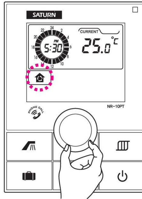
Πατήστε "████" και όταν το εικονίδιο "θέρμανση θερμοκρασίας δωματίου" αρχίσει να αναβοσβήνει χρησιμοποιήστε τον περιστροφικό διακόπτη για να ρυθμίσετε την επιθυμητή θερμοκρασία μεταξύ 10~30°C. Αφήστε τα χειριστήρια και η οθόνη θα ρυθμιστεί αυτόματα. Με το χειρισμό της μονάδας σε αυτή τη λειτουργία, εφαρμόζεται η θερμοκρασία θέρμανσης που ρυθμίστηκε στο στοιχείο "λειτουργία ελέγχου θερμοκρασίας νερού παροχής".
