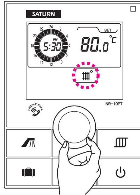
Πατήστε μέχρι το εικονίδιο "☰" "Θέρμανση θερμοκρασίας παροχής" να εμφανιστεί στην οθόνη. Αφήστε το χειριστήριο και η οθόνη θα ρυθμιστεί αυτόματα.
