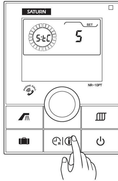
Περιστρέψτε τον περιστροφικό διακόπτη μέχρι το "5: tC" να εμφανιστεί στο εικονίδιο ρολογιού.
